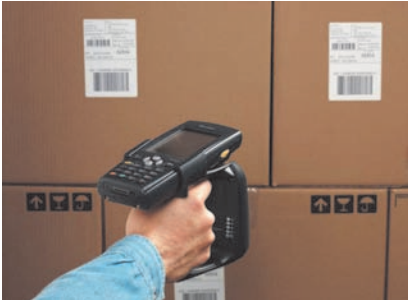
Figura IV.14 Reader portatile legge/scrive etichette intelligenti IP3pro4. - Intermec
